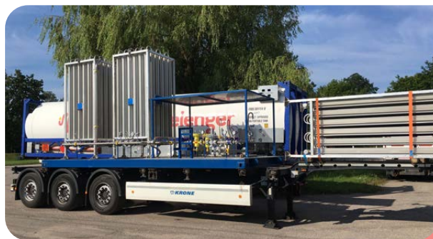
Mobilna stacja regazyfikacji LNG Elenger
